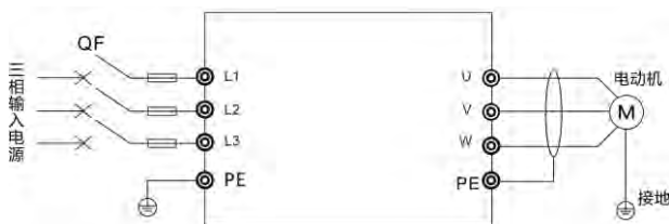
图4-1 试运行接线图
